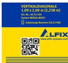
Étiquette apposée, sur les traverses tubulaires, permettant l'identification simple de la longueur de travée et, sur les diagonales, pour l'identification de la longueur de travée et de la hauteur de construction.
