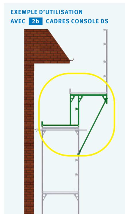
Lorsque l'échafaudage est utilisé par différents corps de métier, le recours aux cadres en console DS d'ALFIX permet de renoncer aux constructions composées de nombreux éléments utilisées jusqu'à présent.
