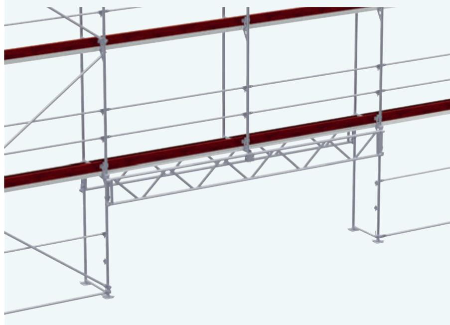
EXEMPLE D'UTILISATION 06 FIXATION MURALE pour 01 POUTRE EN TREILLIS
