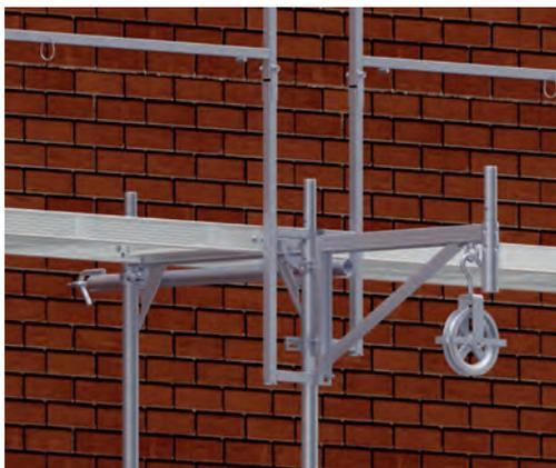
9. Pour faciliter le transport vertical, utiliser des équipements de levage de charges conformes aux Règles TRBS 2121-1 pour les grands échafaudages. Pour ce faire, une console avec poulie de manutention peut être montée dans l'évidement situé entre les colliers des garde-corps TRBS. Le cadre doté de la console pour poulie de manutention doit être fixé au moyen d'ancrages triangulaires ou de fixations d'échafaudage longues.
